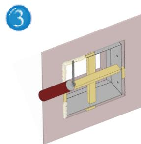
Inserite nella fessura tra il telaio e la muratura la schiuma poliuretanic e lasciatela asciugare per il tempo indicate sulle istruzioni fornite dal produttore.
